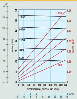
4-SERIES LOW-FLOW GEAR PUMP MAG-DRIVE
